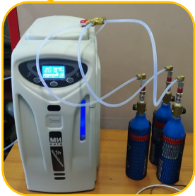
Elettrolizzatore PEM e bombole ad idruri metallici
